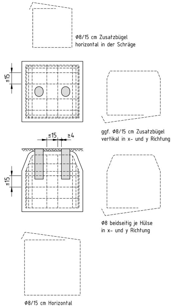
Abgestimmt auf Außenmaße, bzw. Abschrägungen und Lage der Fundamenthülsen sind Bewehrung mit Einzelstäben ( $\varnothing d = 8$  mm, Abstand  $a \leq 15$  cm) durchzuführen. Hierbei sind Form der Fundamente, Betonüberdeckung, Lage der Hülsen und Übergreifungslänge der Bewehrung zu berücksichtigen.
