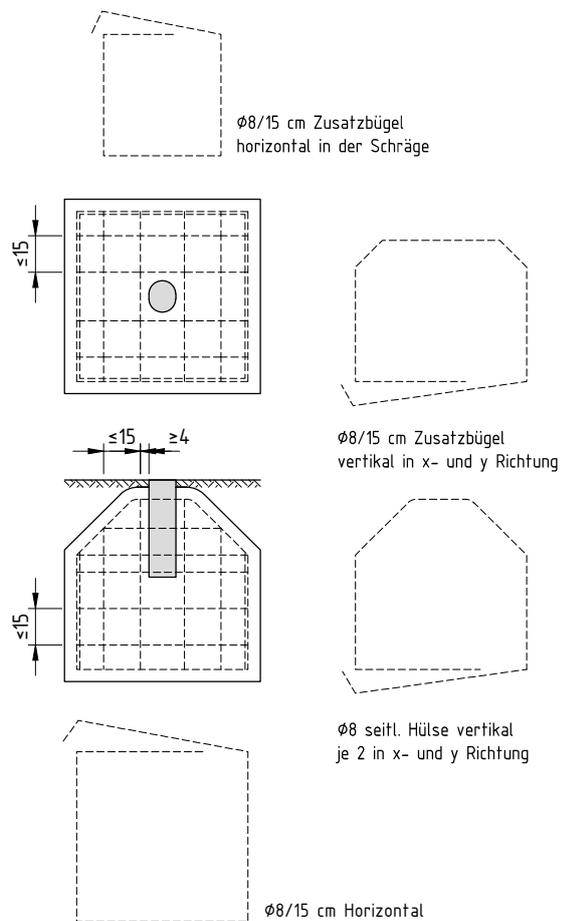
Abgestimmt auf Außenmaße, bzw. Abschrägungen und Lage der Fundamenthülsen sind Bewehrung mit Einzelstäben (Ø d = 8 mm, Abstand a ≤ 15 cm) durchzuführen. Hierbei sind Form der Fundamente, Betonüberdeckung, Lage der Hülsen und Übergreifungslänge der Bewehrung zu berücksichtigen.
