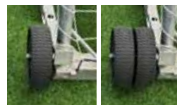
Angeschweißte pannensichere (Doppel-)Räder , siehe Seite 60.
