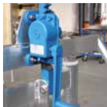
Zahnstangenwinde zur Höhenverstellung.
