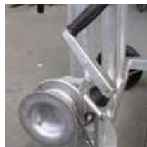
Seilwinde zur Neigungs- verstellung.
